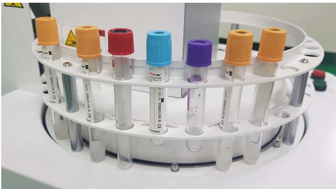
< Korrekt placerede blodprøverør >
