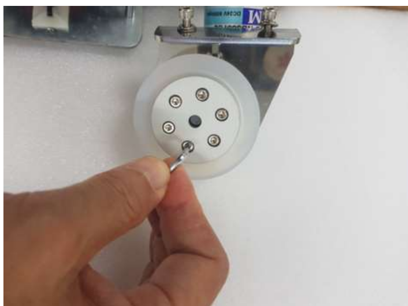
< Afmontering af pladen og udskiftning af silikonehjulet >
