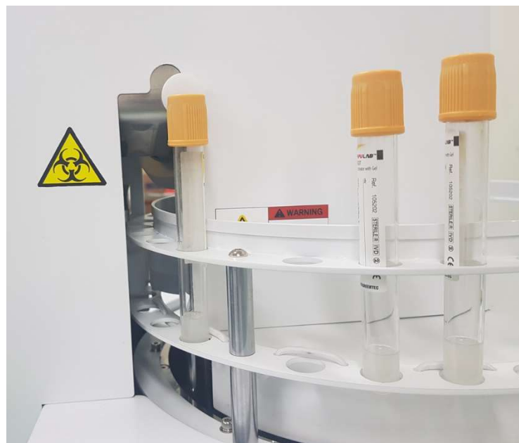
< Forkert monteret blodprøveør >
